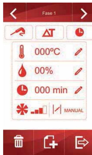
SISTEMA DE COCCIÓN ΔT PERMITE MANTENER UN BAJO DIFERENCIAL ENTRE LA TEMPERATURA DE COCCIÓN DE LA CÁMARA Y EL INTERIOR DEL ALIMENTO
