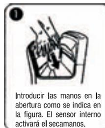
Introducir las manos en la abertura como se indica en la figura. El sensor interno activará el secamanos.
